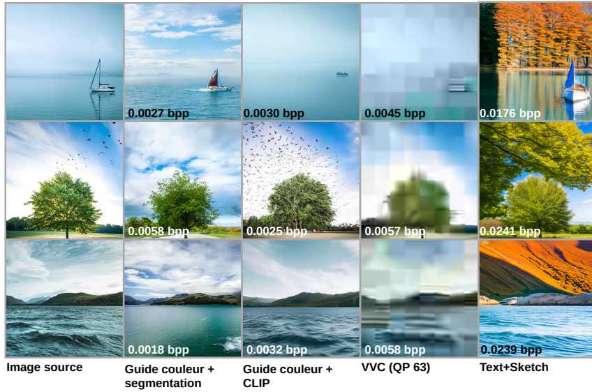
FIGURE 4 : Comparaison du guidage couleur par rapport à d’autres méthodes de compression sémantique très bas débit et à un codeur classique : VVC.
